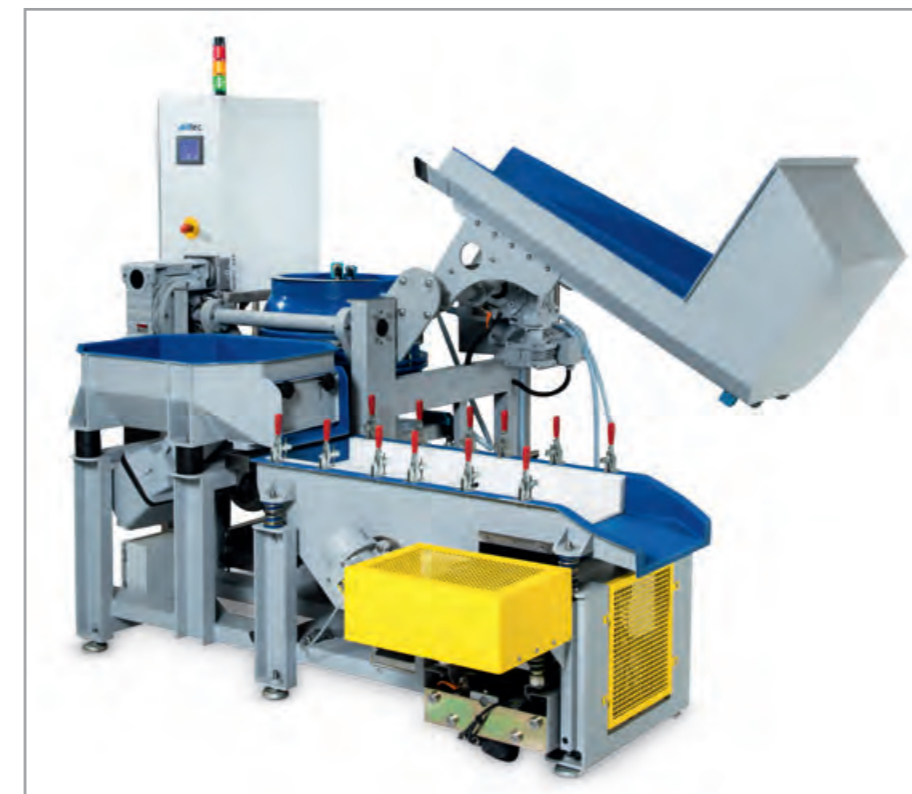
Die Firma AVAtec GmbH, Tochterfirma von Ing. Schnür + Haller KG, konzipiert Maschinen, die genau auf die Anforderungen der Kunden abgestimmt sind. Das Bild zeigt die Tellerfliehkraftmaschine TE 60 A mit automatischer Separierung und Rückführung der Schleifkörper. Copyright: AVAtec GmbH.
