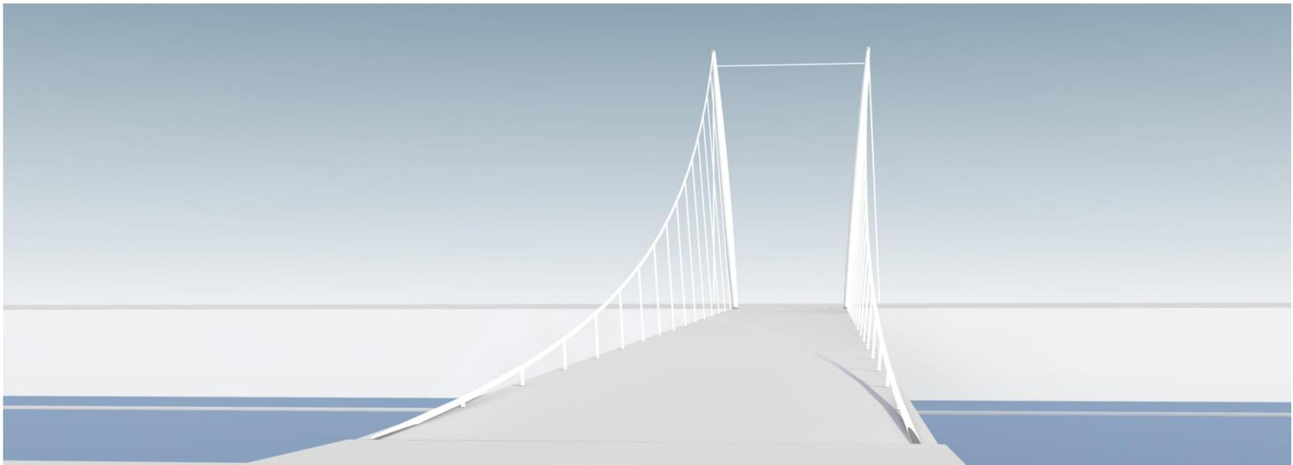
Die Variante 4 ist eine rückverankerte einhüftige Hängebrücke, bestehend aus zwei Masten, zwei Trag- und Abspannseilen und geneigten Hängern. Die Querträger sind über die Hänger des Tragseils abgehängt und tragen die Betonplatte. Die beiden Masten werden mit Abspannseilen gehalten, in Querrichtung werden die Masten untereinander verbunden um genügend Querstabilität zu gewährleisten.
